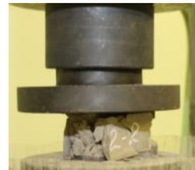
Механические испытания образцов МКФ-керамики с включениями ила
