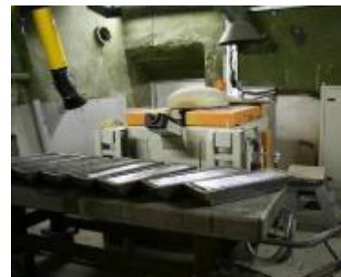
Дезактивация РАО из алюминиевых сплавов
