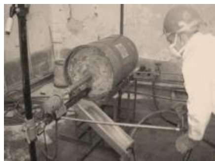
Отбор проб образцов МКФ-керамики с включениями и без включений ила
