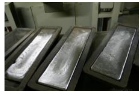
Дезактивация РАО из алюминиевых сплавов
