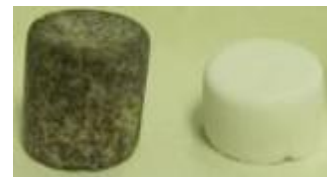
Отбор проб образцов МКФ-керамики с включениями и без включений ила
