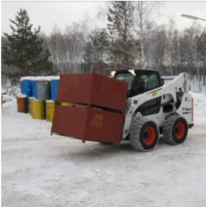
Транспортировка контейнеров МК-1,36 Контейнеры с РАО на площадке временного хранения
