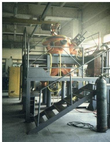
**Принцип реализации:** формирование малых объемов металла из постоянно присутствующей во вращающемся тигле ванны расплава с затвердевание распыленных капель в виде порошка со сферической или чешуйчатой формой частиц
