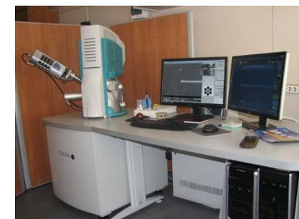
Электронный сканирующий микроскоп TESCAN
