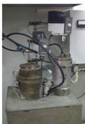
Лабораторная установка восстановления хлоридов металлов
